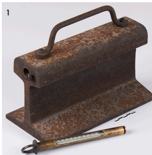
1: Dette skinnertermometer blev overdraget til museet i juli 2017. Museet valgte at optage det i samlingen, fordi det er et vigtigt instrument, som er særligt for jernbanen. Metal udvider sig og trækker sig sammen alt efter temperatur. Det har betydning, når man lægger et jernbanspor. Skinnerne skal lægges med tilstrækkelig afstand mellem enderne, så der er plads til udvidelse – ellers kan det gå galt, når stålet udvider sig på en varm sommerdag.
