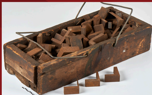
Kasse med skinneblik i forskellige størrelser. De har været anvendt som afstandsstykker, når man lagde skinner.
