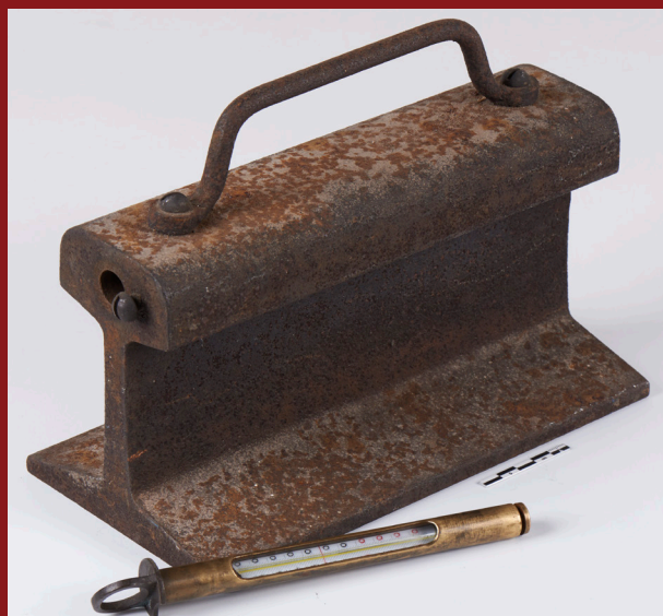
Termometeret er i sig selv ret simpelt: Et stykke skinne med et termometer i et messingrør, som placeres i et lille hul i skinnens ene ende.
