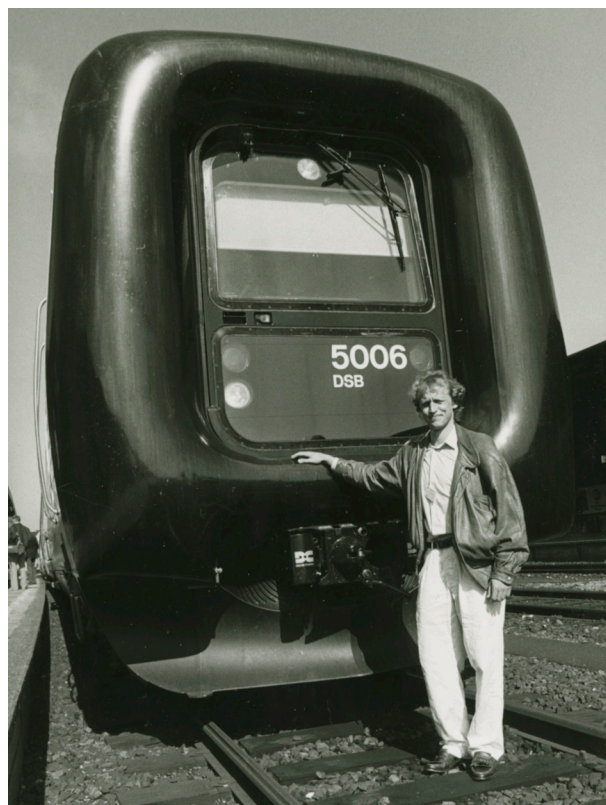
Blandt de mange nye funktionaliteter ved IC 3-toget var den automatiske sammenkobling og den helt særlige gummifront. På billedet ses en af idémændene bag toget, civilingeniør Niels Tougaard Nielsen, der oprindeligt blev ansat i Køreplanskontoret.
